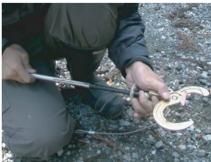
写真5-4 足錠（S社製）。棒の先に取り付けて使用。 足に触れると自動的に閉鎖する仕組みになっている。
